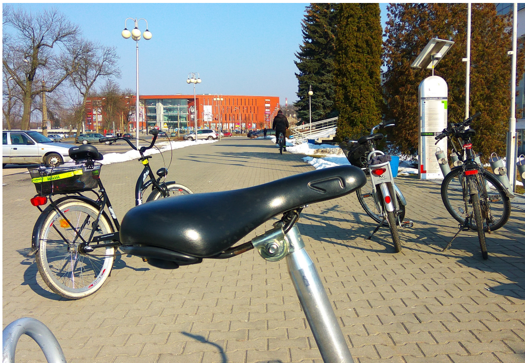
Zdjęcie 1. Siodelko ustawione pod niewłaściwym kontem.
